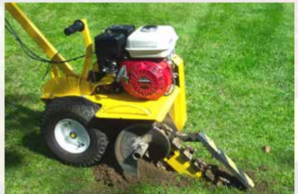
Die Räder werden automatisch blockiert, um ein selbsttätiges Fortlaufen der TR-12 zu verhindern.
