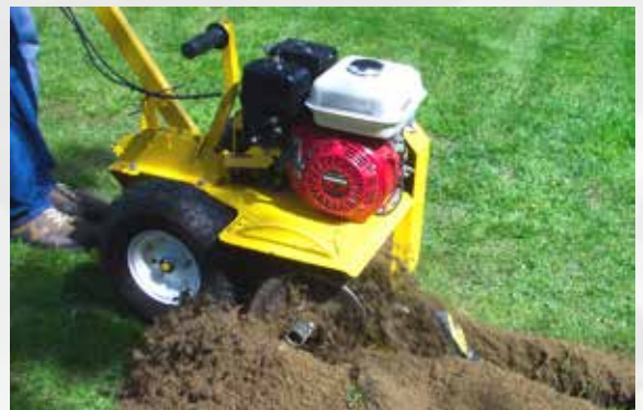
Seitlicher Erdbodenauswurf durch Förderschnecke.
